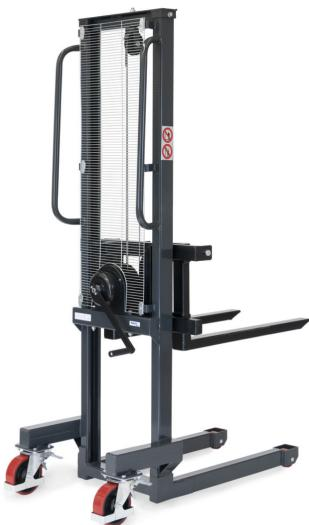
Für den gelegentlichen Einsatz als Hub- und Transportgerät. Stabile Profilstahl-Konstruktion mit Rohrschiebegriffen, pulverbeschichtet anthrazitgrau RAL 7016. Hubantrieb durch Sicherheits-Handwinde. Gabeln verstellbar. Gabelbreite 75 mm. 2 Lenkrollen, Räder Polyurethan-Bereifung und 2 Gabelrollen Nylon. Lenkrollen mit Feststeller. Lastschwerpunktabstand: 400 mm. Hub pro Kurbelumdrehung: 40 mm. 2 Jahre Garantie
