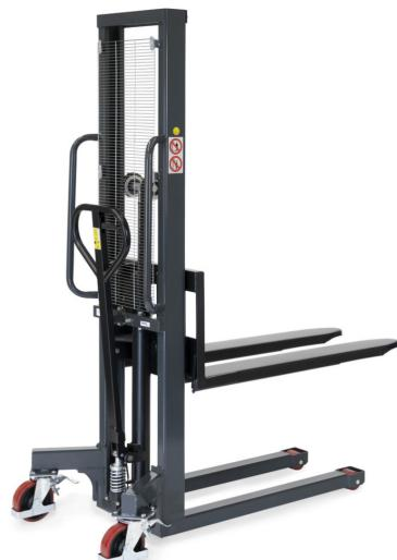
Für den gelegentlichen Einsatz als Hub- und Transportgerät. Stabile Profilstahl-Konstruktion mit Rohrschiebegriffen, pulverbeschichtet anthrazit RAL 7016. Hydraulikpumpe mit verchromten Kolben und Überlastventil. Betätigung über Zugdeichsel. Senkventil über Handhebel. 2 Lenkketten, Räder Polyurethan-Bereifung und 2 Gabelrollen Nylon. Lenkketten mit Feststeller. Lastschwerpunktabstand 585 mm. Gabelbreite 160 mm. Hub pro Deichselschlag 12,5 mm. 2 Jahre Garantie.
