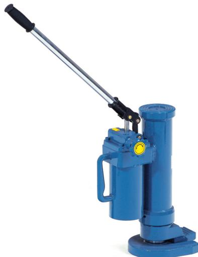
Maschinenheber zum Heben mit Hubklaue und Kopfplatte und durch eingebaute Hand-Hydraulikpumpe mit wenig Kraftaufwand möglich. Feinfühliges Senken über Senkventil, Überlastventil. Pumpehebel abnehmbar. Das Gehäuse ist um 360° drehbar, in jeder Lage einsetzbar. Stabile Stahl-Kompakt-Konstruktion, Beschichtung blau RAL 5007. Hubbereich an Hubklaue 6932: 30-260 mm; Hubbereich an Kopfplatte 6932: 420-650 mm.
