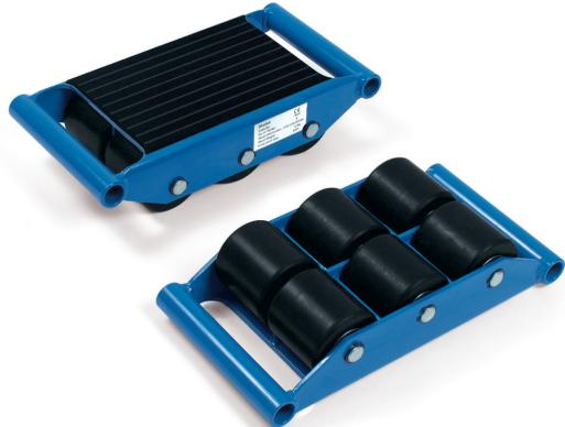
Für den leichten und sicheren Transport von schweren Gegenständen wie Behälter, Kisten, Maschinen usw. Stabile Stahl-Schweißkonstruktion, mit Handgriffen aus Rundstahl oder Stahlrohr, pulverbeschichtet blau RAL 5007. Tragplatten mit rutschhemmender Gummiauflage versehen. Große Nylonrollen kugelgelagert. Hohe Tragkraft bei geringem Eigengewicht. Rollengröße Ø x Breite 85x85 mm. Lieferumfang: 1 Stück
