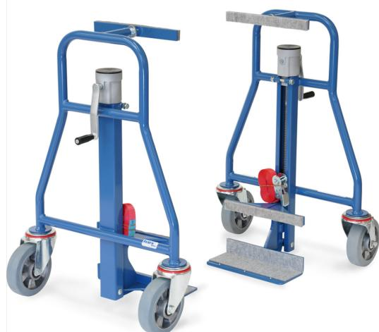
Mit Hand-Spindelwinde für den sicheren 1-Mann-Transport von Schränken. Stahlrohr-Konstruktion pulverbeschichtet blau RAL 5007, Winde mit Handkurbel, Spindel geschützt in einem C-Profil. Verstellbare Anlagestützen mit Schonbelag. Ladeplatte mit rutschhemmendem Belag. 2 Lenkketten, Räder mit bodenschonender und spurloser Elastic-Vollgummi-Bereifung 160 x 50 mm, Nabens mit Kugellager. 1 fest angebrachter Zurrriegel 5 m lang. Lieferung paarweise.
