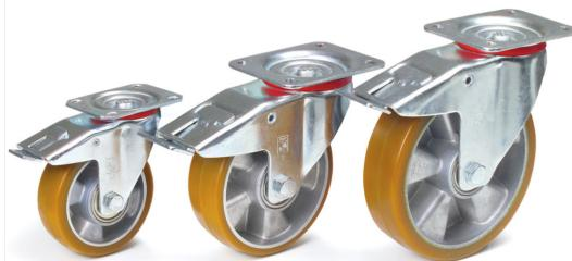
Mit Feststeller Doppelstopp. Gehäuse Stahlblech verzinkt. Räder mit Elastic-Bereifung, Alu-Felgen, Nabenscheiben mit Kugellager. Leichter, elastischer Lauf, hohe Lebensdauer.
