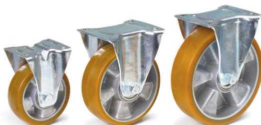
Gehäuse Stahlblech verzinkt. Räder mit Elastic-Bereifung, Alu-Felgen, Nabenscheiben mit Kugellager. Leichter, elastischer Lauf, hohe Lebensdauer.
