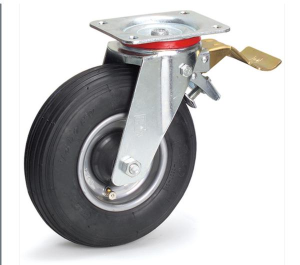
Gehäuse Stahlblech verzinkt, Räder mit schwarzen Luftreifen auf Stahlblech-Felgen, Nabens mit Rollenlager.
