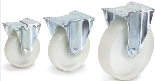
Gehäuse Stahlblech verzinkt. Räder aus Polyamid, Naben mit Rollenlager. Weitgehend beständig gegen Salzwasser, Laugen und Säuren. Temperaturbeständig von -40° bis +90° C.
