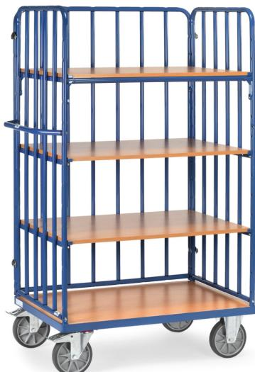
Baukasten-System: Aus Stahlrohr und Profilstahl geschweißt, pulverbeschichtet blau RAL 5007, Schraubkonstruktion. Stirnwände mit vertikalen Rohrstreben im Abstand von 130 mm. 1 Längswand mit Rohrstreben zum Einhängen. 1 fester und 3 lose Einlegeböden aus Holzwerkstoffplatten, Oberfläche Buchendekor. Einlegeböden variabel einsetzbar, Teilung 100 mm. Tragkraft pro Einlegeboden 90 kg. 2 Lenk- und 2 Bockrollen, TPE-Bereifung, Naben mit Rillenkugellager. Feststeller an den Lenkrollen.
