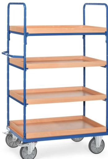
Baukasten-System: Aus Stahlrohr und Profilstahl geschweißt, pulverbeschichtet blau RAL 5007, Schraubkonstruktion. Stirnwände offen. 1 fester und 3 Einlegekästen aus Holzwerkstoffplatten, Oberfläche Buchendekor. Einlegekästen variabel einsetzbar, Teilung 100 mm. Tragkraft pro Einlegekasten 120 kg. 2 Lenk- und 2 Bockrollen, TPE-Bereifung, Naben mit Rillenkugellager. Feststeller an den Lenkrollen.
