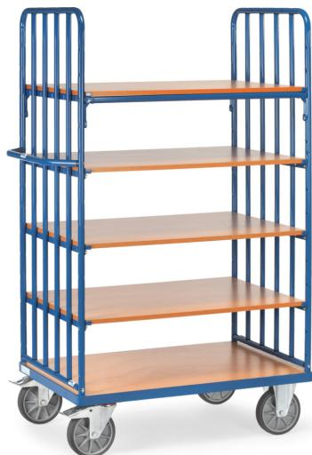
Baukasten-System: Aus Stahlrohr und Profilstahl geschweißt, pulverbeschichtet blau RAL 5007, Schraubkonstruktion. Stirnwände mit vertikalen Rohrstreben im Abstand von 130 mm. 1 fester und 4 lose Einlegeböden aus Holzwerkstoffplatten, Oberfläche Buchendekor. Einlegeböden variabel einsetzbar, Teilung 100 mm. Tragkraft pro Einlegeboden 90 kg. 2 Lenk- und 2 Bockrollen, TPE-Bereifung, Nabensicherung mit Rillenkugellager. Feststeller an den Lenkrollen.
