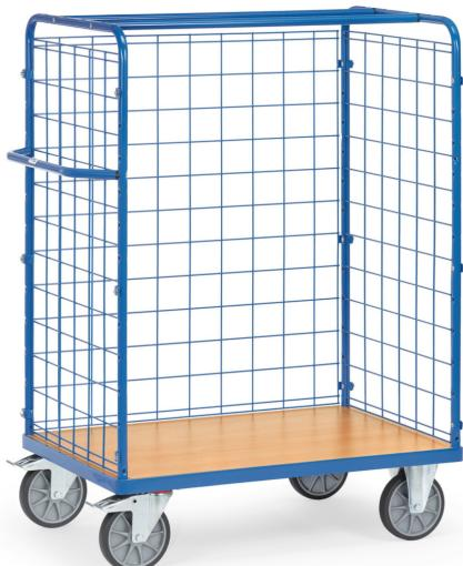
Baukasten-System, Stahlrohr und Profilstahl geschweißt, pulverbeschichtet blau RAL 5007, Schraubkonstruktion. Stirnwände und eine Längswand geschlossen mit Drahtgitter 100 x 100 x 5 mm. Plattform Holzwerkstoffplatte, Oberfläche Buchendekor. Beräderung: 2 Lenk- und 2 Bockrollen, TPE-Bereifung, Nabenhügel mit Rillenkugellager. Feststeller an den Lenkrollen.
