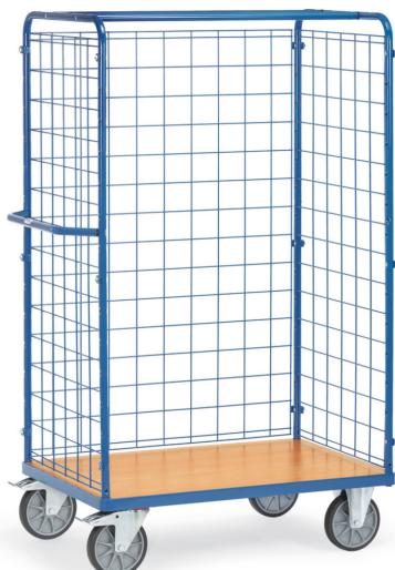
Baukasten-System, Stahlrohr und Profilstahl geschweißt, pulverbeschichtet blau RAL 5007, Schraubkonstruktion. Stirnwände und eine Längswand geschlossen mit Drahtgitter 100 x 100 x 5 mm. Plattform Holzwerkstoffplatte, Oberfläche Buchendekor. Beräderung: 2 Lenk- und 2 Bockrollen, TPE-Bereifung, Nabenhügel mit Rillenkugellager. Feststeller an den Lenkrollen.
