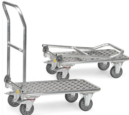
Elektrisch leitfähige Ausführung. Alurohrwagen mit Aluplattform, Schiebebügel auf Plattform klappbar. 2 Lenk- und 2 Bockrollen, TPE-ESD-Bereifung (thermoplastisches Elastomer), elektrisch leitfähig, Naben mit Rillenkugellager. Feststeller an den Lenkrollen.
