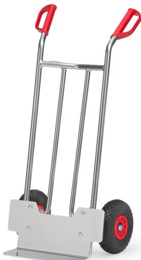
Sackkarre aus Aluminiumrohr mit Aluminiumschaufel, sehr leicht und handlich. Sauber verschweißt und "naturbelassen", Alublechschaufel anschraubbar und dadurch austauschbar. Mit pannensicherer PU-Bereifung auf Kunststoff-Felgen, Nabenhügel mit Rollenlagerung. Bügel oben und Querstreben durchgebogen. Für den sicheren Transport von runden Gütern, wie Rollen, Kannen, Eimern usw.
