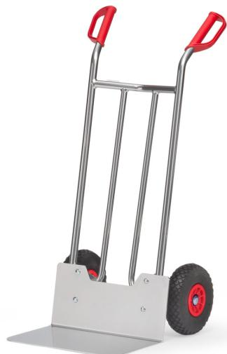
Sackkarre aus Aluminiumrohr mit Aluminiumschaufel, sehr leicht und handlich. Sauber verschweißt und "naturbelassen", Alublechschaufel anschraubbar und dadurch austauschbar. Mit pannensicherer PU-Bereifung auf Kunststoff-Felgen, Nabenhügel mit Rollenlagerung. Bügel oben und Querstreben durchgebogen. Für den sicheren Transport von runden Gütern, wie Rollen, Kannen, Eimern usw.
