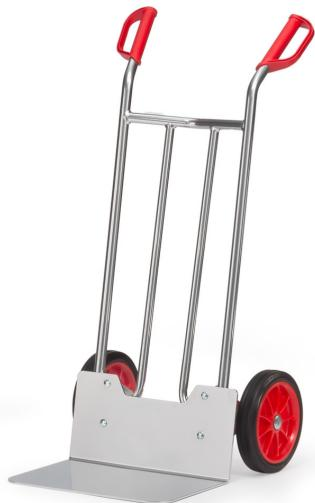
Sackkarre aus Aluminiumrohr mit Aluminiumschaufel, sehr leicht und handlich. Sauber verschweißt und "naturbelassen", Alublechschaufel anschraubbar und dadurch austauschbar. Mit Vollgummibereifung auf Kunststoff-Felgen, Nabensicherung. Bügel oben und Querstreben durchgebogen. Für den sicheren Transport von runden Gütern, wie Rollen, Kannen, Eimern usw.
