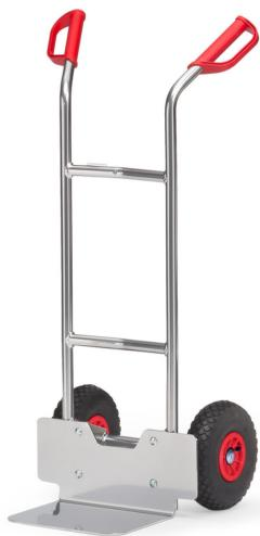
Aus Aluminiumrohr mit Aluminiumschaufel, sehr leicht und handlich. Sauber verschweißt und "naturbelassen", Alublechschaufel anschraubbar und dadurch austauschbar. Mit Luftbereifung auf Kunststoff-Felgen, Nabensicherung. Bügel oben und Querstreben durchgebogen. Für den sicheren Transport von runden Gütern, wie Rollen, Kannen, Eimern usw.
