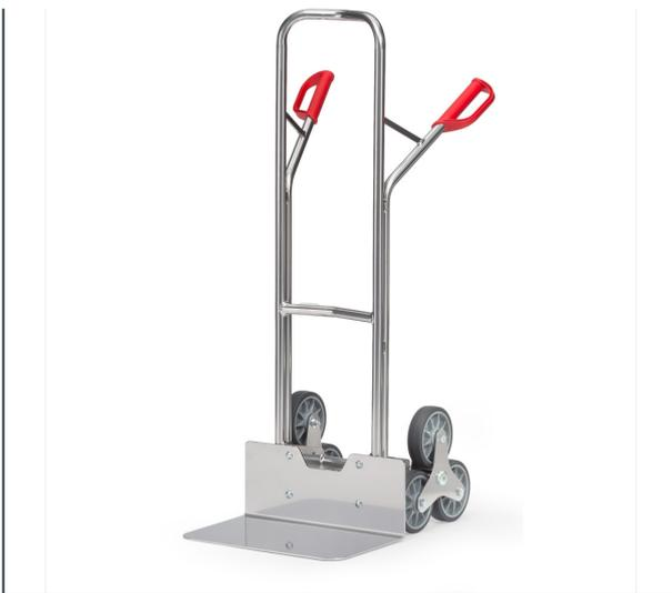
Aus Aluminiumrohr mit Aluminiumschaufel, handliche Schweißkonstruktion. Sicherheitsgriffe. Mit 2 dreiarmigen Rad-Sternen, jeweils 3 TPE-Räder 160 mm Ø, Naben mit Kugellager. Bügel oben und Querstreben durchgebogen. Für den sicheren Transport von runden Gütern, wie Rollen, Kannen, Eimern usw.
