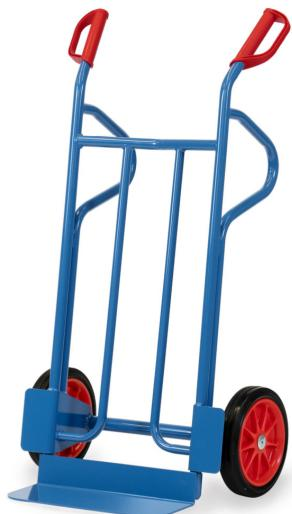
Stahlrohr-Sackkarre mit Stahlblechschaufel, stabile Schweißkonstruktion, pulverbeschichtet, blau, RAL 5007. fetra Sicherheitsgriffe. Stahlblechschaufel anschraubbar und dadurch austauschbar. Räder mit Vollgummibereifung, auf Kunststoff-Felgen, Nabenhügel mit Rollenlagerung. Zerlegte Anlieferung.
