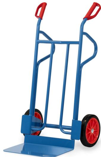
Stahlrohr-Sackkarre mit Stahlblechschaufel, stabile Schweißkonstruktion, pulverbeschichtet, blau, RAL 5007. fetra Sicherheitsgriffe. Stahlblechschaufel anschraubbar und dadurch austauschbar. Räder mit Vollgummibereifung, auf Kunststoff-Felgen, Nabenhügel mit Rollenlagerung. Zerlegte Anlieferung.
