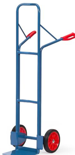
Stahlrohr-Stapelkarre mit Stahlblechschaufel, stabile Schweißkonstruktion, pulverbeschichtet blau RAL 5007. Sicherheitsgriffe. Stahlblechschaufel anschraubbar und dadurch austauschbar. Räder mit Vollgummibereifung, auf Kunststoff-Felgen, Nabensicherung. Bügel oben und Querstreben durchgebogen. Für den sicheren Transport von runden Gütern, wie Rollen, Kannen, Eimern usw. Zerlegte Anlieferung.
