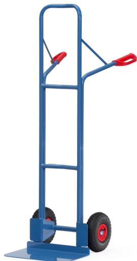
Stahlrohr-Stapelkarre mit Stahlblechschaufel, stabile Schweißkonstruktion, pulverbeschichtet blau RAL 5007. Sicherheitsgriffe. Stahlblechschaufel anschraubbar und dadurch austauschbar. Räder mit Luftbereifung, auf Kunststoff-Felgen, Nabenhügel mit Rollenlagerung. Bügel oben und Querstreben durchgebogen. Für den sicheren Transport von runden Gütern, wie Rollen, Kannen, Eimern usw. Zerlegte Anlieferung.
