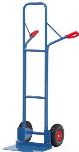
Stahlrohr-Stapelkarre mit Stahlblechschaufel, stabile Schweißkonstruktion, pulverbeschichtet blau RAL 5007. Sicherheitsgriffe. Stahlblechschaufel anschraubar und dadurch austauschbar. Räder mit pannensicherer PU-Bereifung, auf Kunststoff-Felgen, Nabenhügel mit Rollenlagerung. Bügel oben und Querstreben durchgebogen. Für den sicheren Transport von runden Gütern, wie Rollen, Kannen, Eimern usw. Zerlegte Anlieferung.
