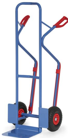
Stahlrohr-Stapelkarre mit Stahlblechschaufel, stabile Schweißkonstruktion, pulverbeschichtet blau RAL 5007. fetra Sicherheitsgriffe. Stahlblechschaufel anschraubar und dadurch austauschbar. Mit auswechselbaren Kunststoff-Gleitkufen. Räder mit pannensicherer PU-Bereifung, auf Kunststoff-Felgen, Nabenhügel mit Rollenlagerung. Bügel oben und Querstreben durchgebogen. Für den sicheren Transport von runden Gütern, wie Rollen, Kannen, Eimern usw. Zerlegte Anlieferung.
