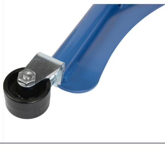
Anlaufrollen für Reifenkarren 2032, 2033, 2034 und 2035. Für den nachträglichen Anbau an die Spreizaufnahme. Einfache Montage mittels Expander-Verschaubung. Die Anlaufrollen sorgen für ein flüssigeres Aufnehmen und Absetzen von Räder- oder Reifenstapeln. Die Spreizarme der Reifenkarre rollen dadurch am Stapel entlang und reduzieren den Kraftaufwand. Nachrüstbar für alle fetra Reifenkarren.
