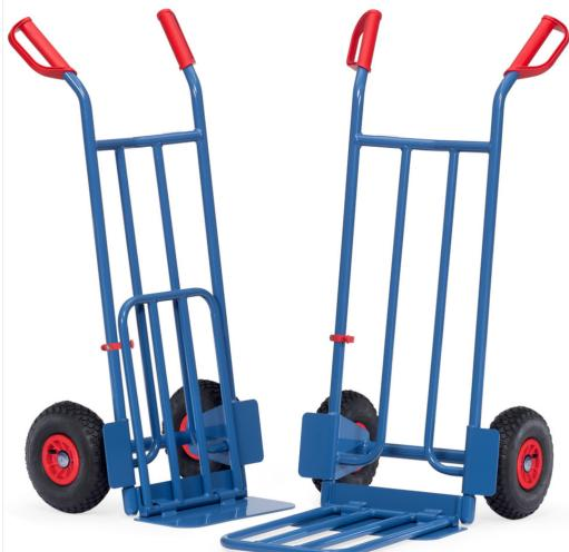
Handlich, mit großer Stahlrohr-Klappschaufel 500 x 330 mm. Stabile Schweißkonstruktion, pulverbeschichtet, blau RAL 5007. Sicherheitsgriffe. Räder mit Luftbereifung auf Kunststoff-Felgen. Nabenhügel oben und Querstreben durchgebogen. Für den sicheren Transport von runden Gütern, wie Rollen, Kannen, Eimern usw. Zerlegte Anlieferung.
