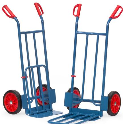
Handlich, mit großer Stahlrohr-Klappschaufel 500 x 330 mm. Stabile Schweißkonstruktion, pulverbeschichtet, blau RAL 5007. Sicherheitsgriffe. Räder mit Vollgummibereifung auf Kunststoff-Felgen. Nabenhügel mit Rollenlager. Bügel oben und Querstreben durchgebogen. Für den sicheren Transport von runden Gütern, wie Rollen, Kannen, Eimern usw. Zerlegte Anlieferung.
