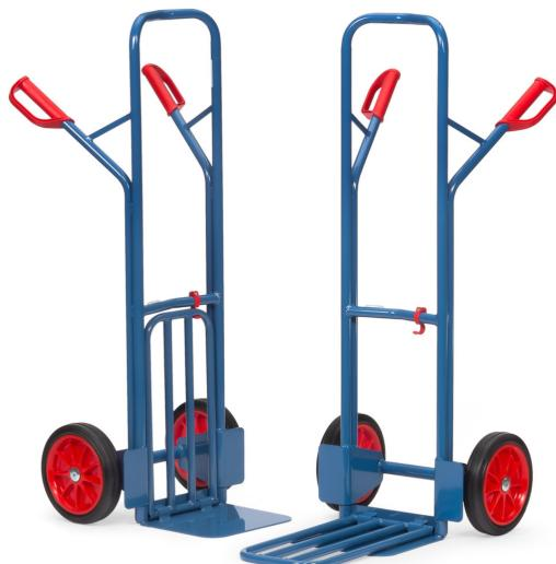
Handlich, mit großer Stahlrohr-Klappschaufel 500 x 250 mm. Stabile Schweißkonstruktion, pulverbeschichtet, blau RAL 5007. Sicherheitsgriffe. Räder mit Vollgummibereifung auf Kunststoff-Felgen. Nabenhügel mit Rollenlager. Bügel oben und Querstreben durchgebogen. Für den sicheren Transport von runden Gütern, wie Rollen, Kannen, Eimern usw. Zerlegte Anlieferung.
