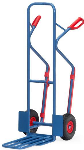
Handlich, mit großer Stahlrohr-Klappschaufel 500 x 250 mm. Stabile Schweißkonstruktion, pulverbeschichtet, blau RAL 5007. Sicherheitsgriffe. Räder mit pannensicherer PU-Bereifung auf Kunststoff-Felgen. Nabenhügel oben und Querstreben durchgebogen. Für den sicheren Transport von runden Gütern, wie Rollen, Kannen, Eimern usw. Zerlegte Anlieferung.
