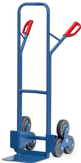
Stabile Schweißkonstruktion, mit Stahlblechschaufel, pulverbeschichtet, blau RAL 5007. Sicherheitsgriffe. Zerlegte Anlieferung. Mit 2 dreiarmigen Rad-Sternen, jeweils 3 TPE-Räder 160 mm Ø, Nabenhügel mit Kugellager. Bügel oben und Querstreben durchgebogen. Für den sicheren Transport von runden Gütern, wie Rollen, Kannen, Eimern usw.
