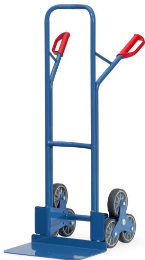
Stabile Schweißkonstruktion, mit Stahlblechschaufel, pulverbeschichtet, blau RAL 5007. Sicherheitsgriffe. Zerlegte Anlieferung. Mit 2 dreiarmigen Rad-Sternen, jeweils 3 TPE-Räder 160 mm Ø, Naben mit Kugellager. Bügel oben und Querstreben durchgebogen. Für den sicheren Transport von runden Gütern, wie Rollen, Kannen, Eimern usw.
